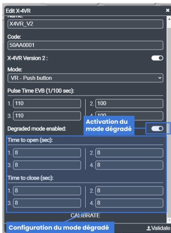
Le mode de fonctionnement de l'extension X-4VR V2 lors de sa sortie d'usine est le mode n°1, avec l'utilisation de deux boutons poussoirs. Pour changer de mode, rendez-vous à la section Interaction.
