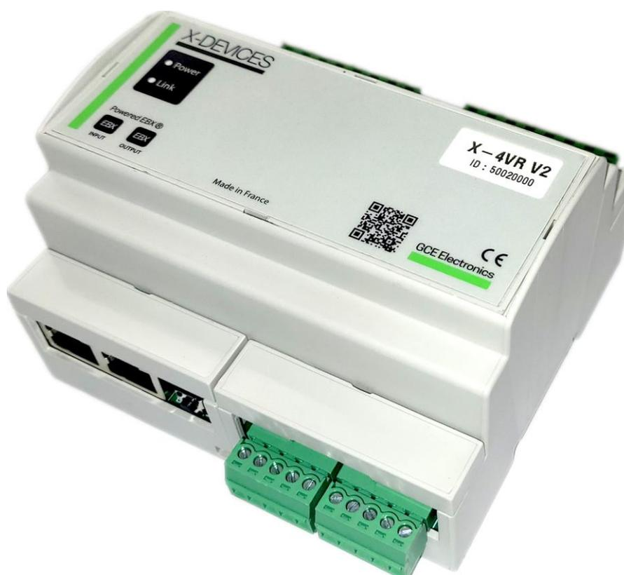
L'extension X-4VR V2 permet d'intégrer le pilotage de quatre volets roulants (ou BSO). Elle intègre divers modes de pilotage et la possibilité d'obtenir la position des volets roulants en retour d'état. Il est possible d'associer jusqu'à huit extensions X-4VR V2 à une IPX800 V4 et ainsi piloter jusqu'à trente-deux volets roulants.
