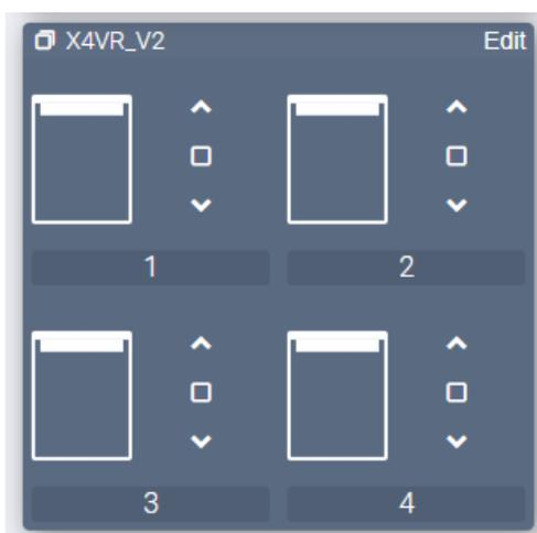
Il est possible de piloter chaque volet roulant en position en passant soit par le moteur de lien, soit pas le moteur de scénarios en transmettant une valeur analogique comprise entre 0 et 100 (%) aux entrées analogiques de consigne de l'objet de l'extension X-4VR. Ces entrées analogiques de consigne sont accessibles depuis la section "Link/Extensions/X-4VR/Position".
