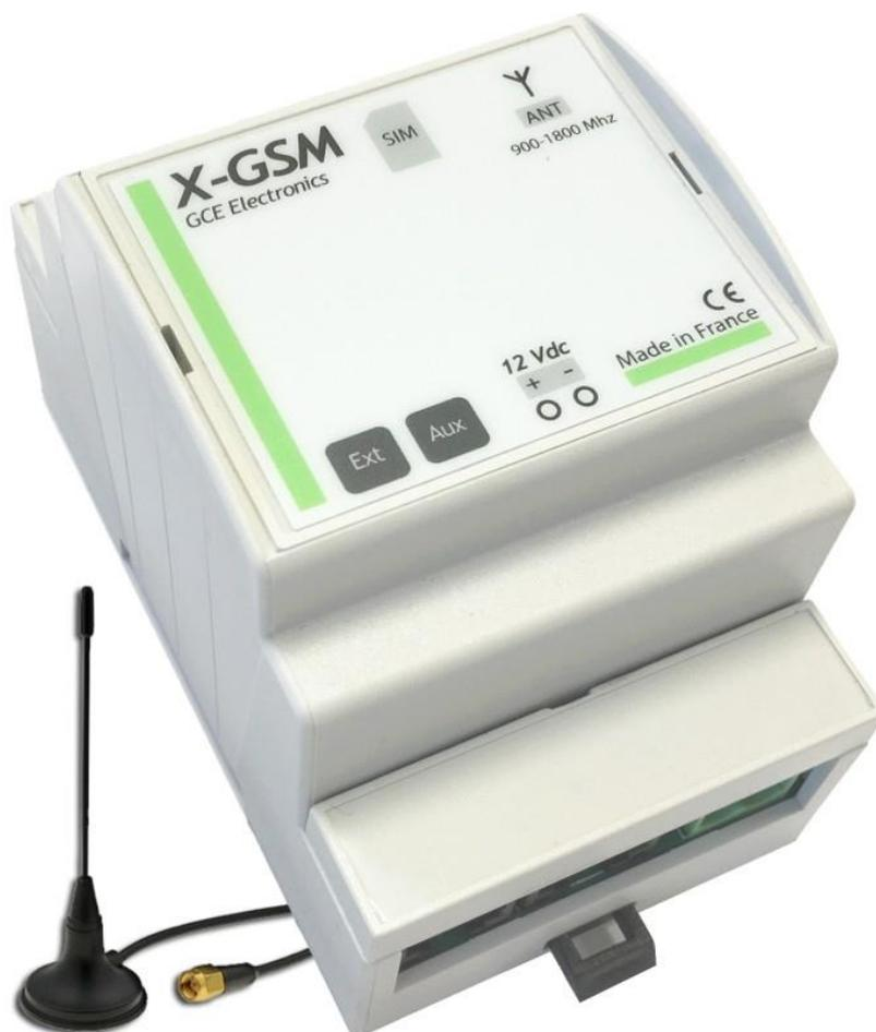
L'extension X-GSM\_2 permet d'intégrer dans l'univers de la V5 et de la V4 l'envoi et la réception de SMS. Ces SMS pourront être interprétés dans les automates via des scénarios programmables sur l'interface de l'IPX.
